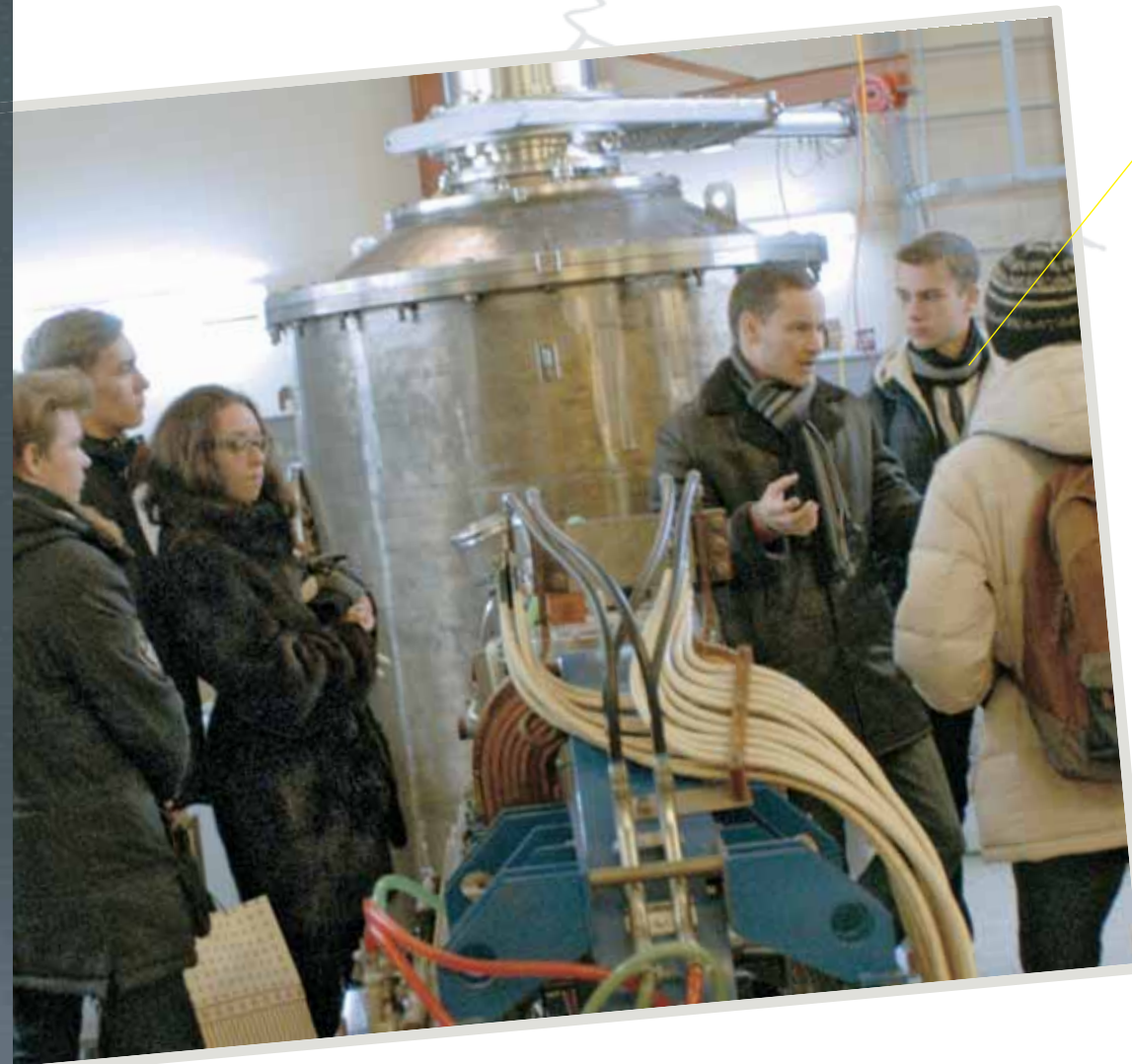
Главная часть установки для БНЗТ – ускоритель нового типа, генерирующий пучок эпитепловых протонов. На фото – сотрудник лаборатории бор-нейтронзахватной терапии Александр Макаров рассказывает о принципах работы уникального ускорителя очередной экскурсии новосибирских школьников
