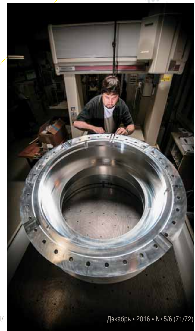
Элемент магнита транспортного канала. Транспортный канал будет состоять из 27 сверхпроводящих магнитов. Credit: Fermilab
